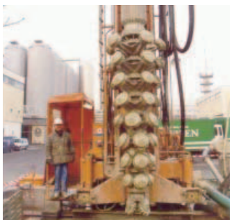
Bohrwerkzeug: mehrstufiger Rollenmeißel
