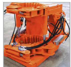
Verrohrungsmaschine oszillierend bis Ø 832 mm
